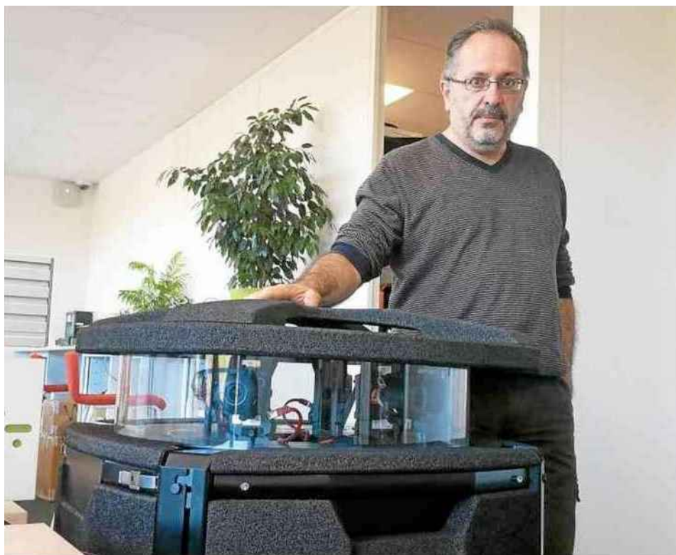
Le système « C2 All Around » peut accueillir jusqu'à 12 caméras, se pilote depuis un simple ordinateur relié en WiFi et ne nécessite aucune installation pour filmer en multi-vues.
